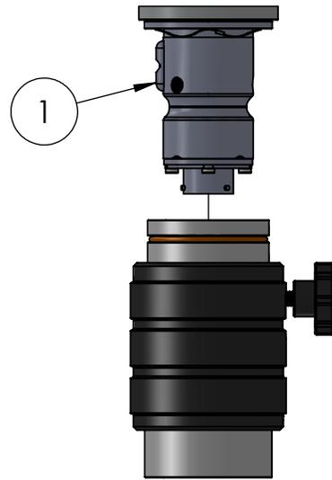
STEP 2: ALIGN SPINDLE KEY (1)
